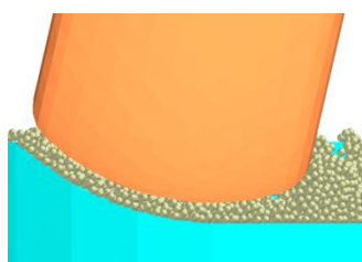
图 13 磨盘磨辊间隙处颗粒群
